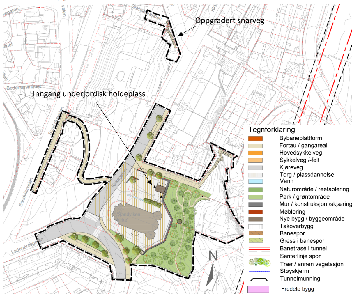
Figur 6-8: Utsnitt som viser løsninger som reguleres i dagen på strekningen Sandbrogaten – Amalie Skrams vei. Øvrige tiltak, inklusive underjordisk holdeplass Sandvikskirken, ligger under bakken.
